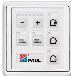
Panel obsługi manualnej 7-stopniowej (dł x wys x gł : 80x80x12 mm) z program załączenia PEHA Kabel: IYSTY 2x2x0,6; max. 15 m
