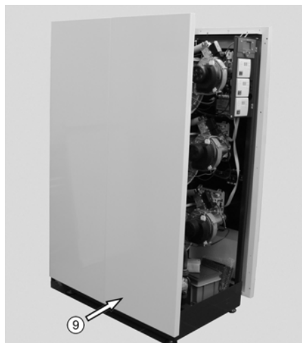
Rys. 33: Przednia część bocznej ściany obudowy kotła ⑨ lekko odgiąć na dole i zdjąć z górnych bolców mocujących.
