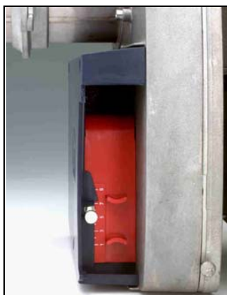
Zdjęcie 12: Tłumik szumów ssania RE 1H oraz suwak ze skalą i ustawieniem
