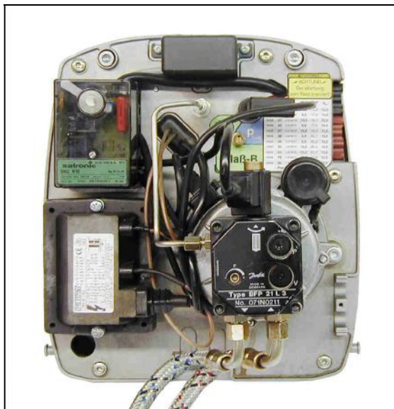
Rys.3. Przejrzyste rozmieszczenie elementów konstrukcyjnych palnika
