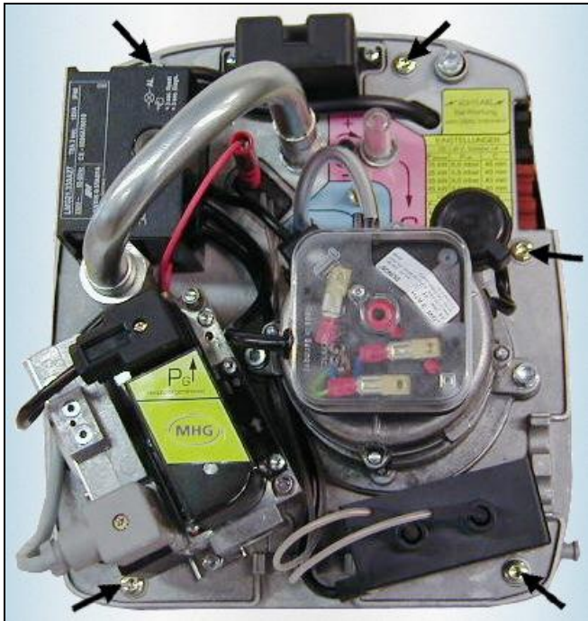
Rys 10:: Śruby mocujące w palniku GE 1H
