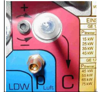
Rys.19: Śruba nastawcza wymiaru B-Maß-Skala
