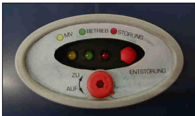
Rys.2: Pole informacyjne diodowe GE 1H żółta LED zawór magnetyczny; zielona LED praca; czerwona LED zakłócenia; Czerwony przycisk sześciokątny - odblokowanie
