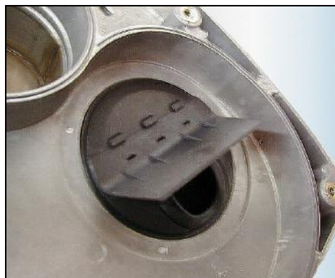
Rys 5 Dysza wlotu powietrza z założoną klapką
