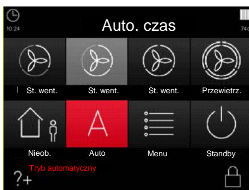
Rys. 11: Tryb automatyczny z aktywnym 2 stopniem wentylacji
