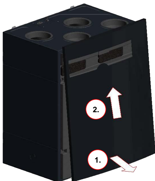
Rys. 43: Zdejmowanie przedniej osłony
